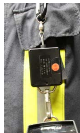
Abbildung 3.5: Aufrollmechanismus an der HuPF-Jacke zur Befestigung der Wärmebildkamera
