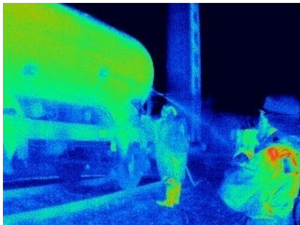
Abbildung 4.12: CSA-Träger beim Abdichten eines Leckgeschlagenen Kesselwagens.
