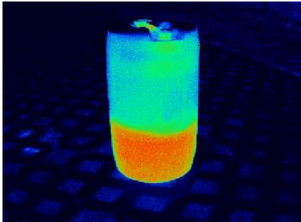
Abbildung 4.8: Der Füllstand eines Fasses lässt sich mit der Wärmebildkamera auf einen Blick bestimmen.
