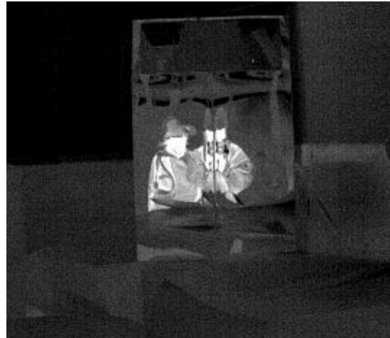
Abbildung 3.11: Der Angriffstrupp spiegelt sich hier in einer Metalltüre einer Produktionsmaschine sehr deutlich.
