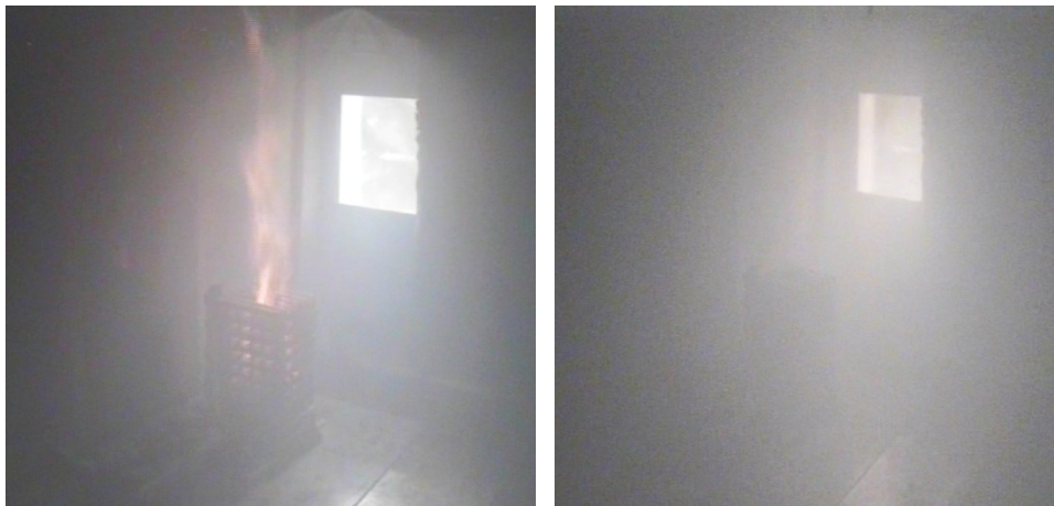
Abbildung 3.19: Auf den Bildern lässt sich erkennen, dass der Brand durch die Löschanlage eingedämmt wird. Die Sicht wird dabei jedoch deutlich schlechter. (Beides Digitalbilder)
