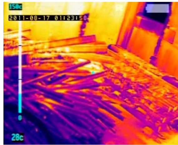
Abbildung 3.24: Falsch eingesetzter dynamischer Farbmodus, der ganze Raum ist noch enorm warm und wird somit eingefärbt.
