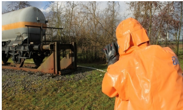
Abbildung 4.11: CSA-Träger mit Wärmebildkamera zur Erkundung.
