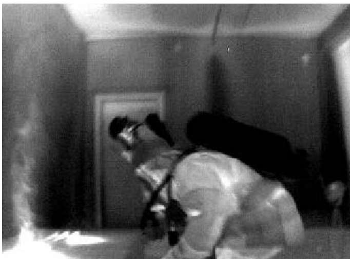
Abbildung 2.21: Hier lässt sich deutlich erkennen, dass heißer Rauch aufsteigt und die Decke erhitzt.
