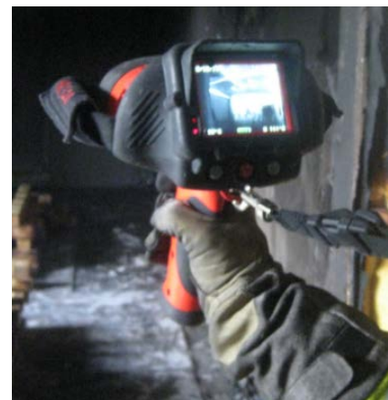
Abbildung 3.22: Der Blick mit der Wärmebildkamera unter die Decke des Brandraumes um Glutnester zu finden.
