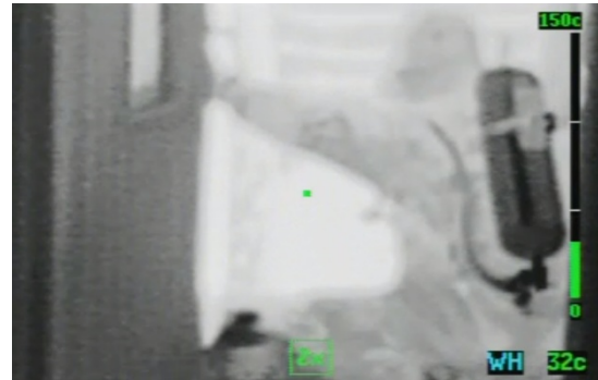
Abbildung 3.14: Hier ist klar zu erkennen, dass der Bereich der Atemluftflasche besser zu erkennen ist als die schwer zu erkennende Silhouette des Feuerwehrmanns.
